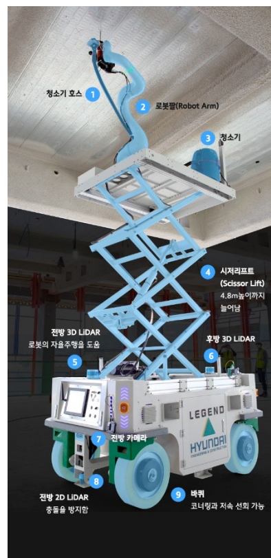
(현대건설) 천장 드릴 타공 로봇 : 자율 주행 및 내장 카메라를 활용한 비전 기반 마커 인식을 통해 작업 수행
