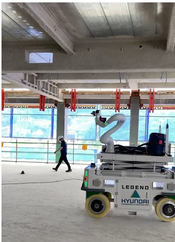
(현대건설) 천장 드릴 타공 로봇 : 자율 주행 및 내장 카메라를 활용한 비전 기반 마커 인식을 통해 작업 수행
