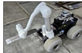
바닥 미장 자동화 로봇
